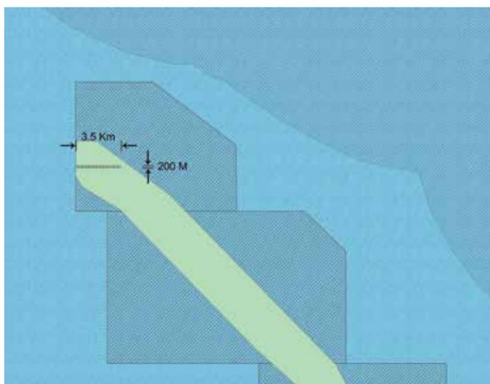
**FIGURA 5.** Imagen de la parte norte del área de arenas minerales "Don Diego", mostrando el 'área activa de dragado' de 1 km<sup>2</sup> por año.
