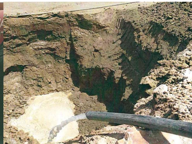
Fotografía N° 07. Incorporación de agua en la calicata con ayuda de un camión cisterna
